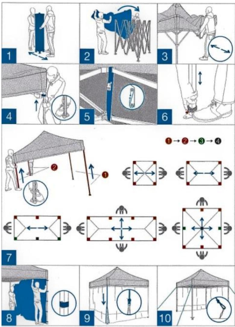
1. Placez le sac de transport sur ses pieds et ôtez le sac, prenez l'armature à deux personnes, reculez d'un pas en ouvrant l'armature de moitié.
